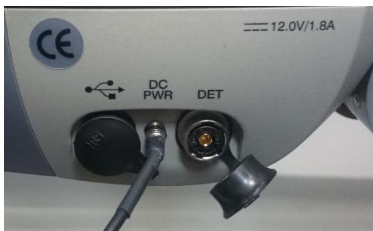
Nakon toga spojiti sondu na gama detektor:
