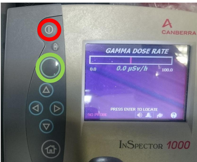
Uređaj automatski pokazuje brzinu doze okoliša. Približavanjem radioaktivnog izvora, uređaj će početi pokazivati veću brzinu doze. Pritiskom na oznaku zvučnika moguće je ugasiti zvuk. Pritiskom na zeleno označenu tipku može se mijenjati prikaz brzine doze i broja događaja. Ukoliko je označen broj događaja, tipkama za lijevo i desno može se mijenjati vremenska skala koja pokazuje broj događaja u vremenu.
