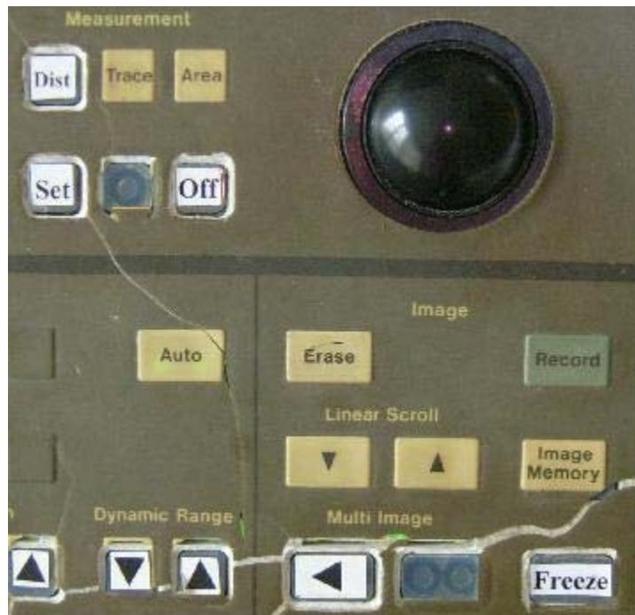
Nakon toga pomoću crne kugle dovesti pokazivač na mjesto koje označava početak tijela koje se mjeri, i pritisnuti tipku Set. ponovno pomoću crne kugle dovesti pokazivač na mjesto koje označava kraj predmeta (ovisno mjerimo li visinu, ili duljinu predmeta), i lijevo od slike očitati vrijednost duljine izraženu u milimetrima (npr. na gornjoj slici 29 mm).
